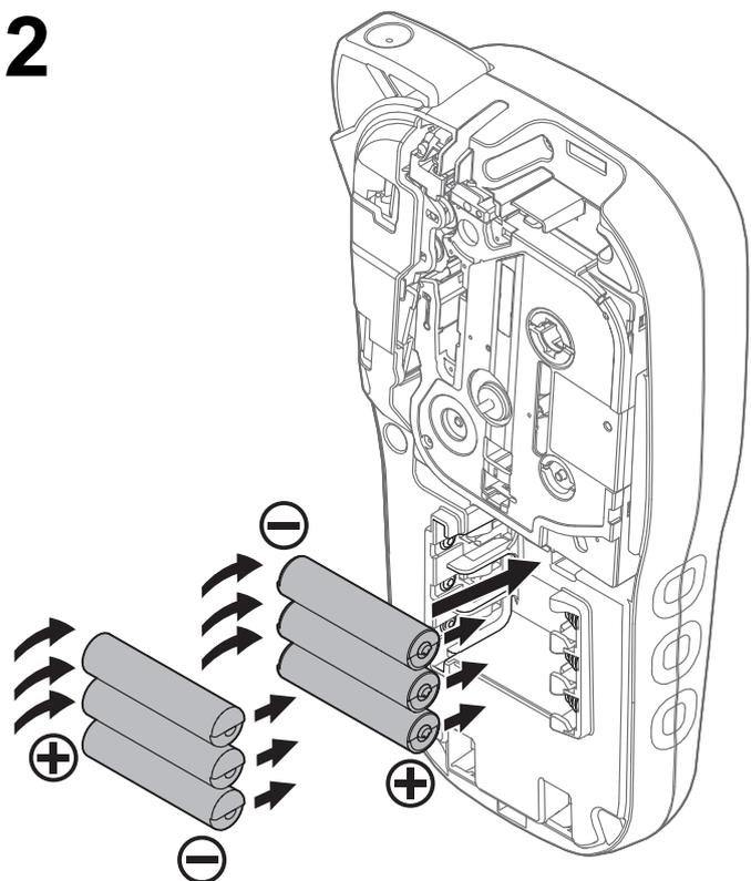
Achten Sie beim Austauschen von Batterien oder Bandkassetten darauf, dass die Stromversorgung ausgeschaltet ist.
