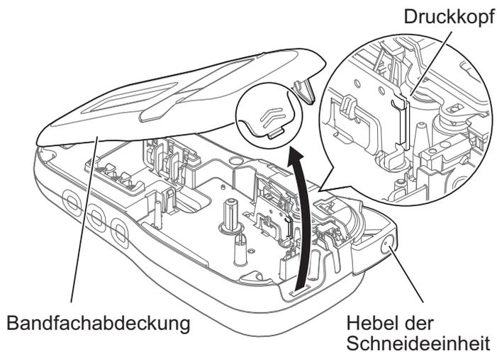
Drehen Sie das Gerät um, sodass das LCD nach unten zeigt. Öffnen Sie die Bandfachabdeckung, indem Sie auf die geriffelte Lasche drücken und die Abdeckung, wie abgebildet, in Pfeilrichtung abnehmen.
