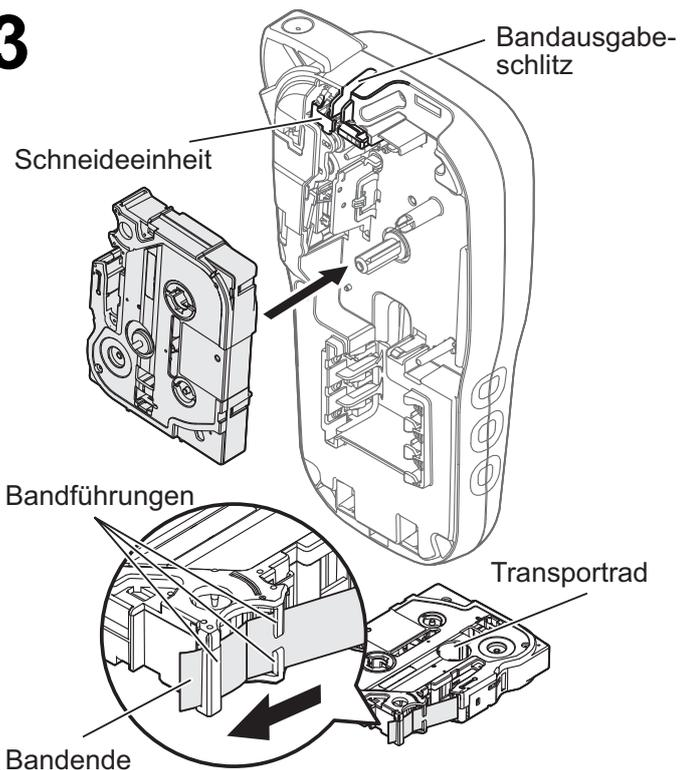
**Legen Sie die Bandkassette gemäß der Abbildung in das Gehäuseinnere ein. Drücken Sie die Bandkassette vorsichtig in das P-touch Beschriftungsgerät, bis sie einrastet.**
