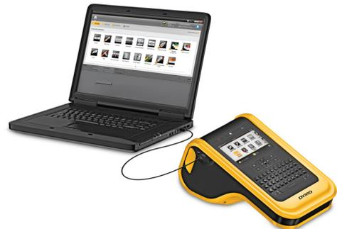
Auf dem Display des Etikettendruckers wird **Verbindung mit PC hergestellt** angezeigt, und das Tastenfeld des Etikettendruckers ist gesperrt.
