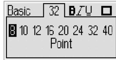
Die verfügbaren Schriftgrößen sind vom ausgewählten Etikett abhängig. Die Schriftgröße wird auf alle Zeichen eines Etiketts angewendet.
